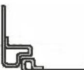
Le procédé de **profilage agrafage** **Seamline®** renforce la résistance des montants, équivalent à une tôle ép. 10/10<sup>ème</sup> pliée.
