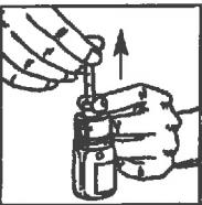
C - Aspirer doucement le réactif n°1 avec la seringue jusqu'à la butée, mais sans aller au-delà de celle-ci.
