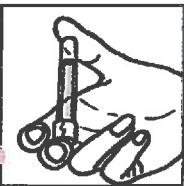
F - Introduire l'extrémité du tube de la pipette dans le tube test contenant le réactif n°1 en appuyant sur la tétine par pressions successives jusqu'à la vidange complète de l'huile.
