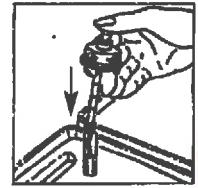
E - Prendre la canule de prélèvement (2) et l'enfoncer dans la poire de prélèvement (1) jusqu'à mi-longueur de la poire (partie dure).
