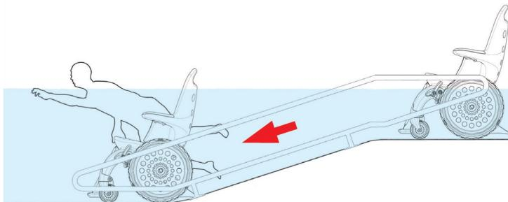
Afin d'assurer une manipulation plus facile et une stabilité plus élevée sur les rampes immergées, le châssis se remplit d'eau rapidement dès son immersion. Hors du bassin, l'eau est très vite évacuée. Les utilisateurs peuvent facilement pénétrer en fauteuil roulant dans une piscine ou un centre thermal, mais également dans les bassins.
