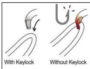
Pour garantir une efficacité optimale lors des manœuvres, les mousquetons OK utilisent le système Keylock : l'interface, composée du corps et du doigt, est dépourvue de crochet, afin d'éviter l'accrochage involontaire du mousqueton sur l'ancre, la corde, le porte-matériel du harnais...
