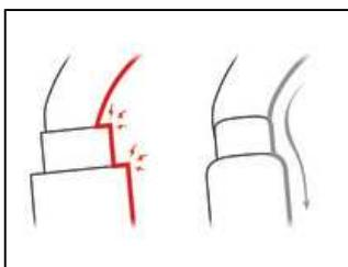
Le design intérieur fluide des mousquetons OK limite le risque de point stable et facilite la rotation du mousqueton.
