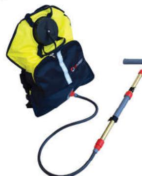
Sac avec intérieur en PVC imperméable très résistant. Muni d'une vanne de connexion rapide avec 1/4 de tour à la sortie du sac permettant le retrait ou la fixation du tuyau (même si le sac est rempli) sans perte de son contenu. Lance double action : jet plein avec portée de 12 m ou brume avec portée de 3 m.
