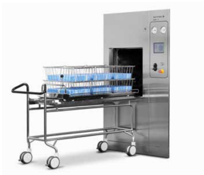
Chargement/déchargement manuel des paniers grillagés, à l'aide du chariot à hauteur fixe de Getinge (FHT).
