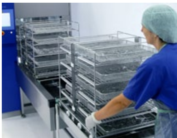
Chargement haute capacité La chambre accepte jusqu'à 15 plateaux DIN.
