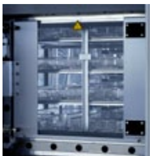
Contrôle à tout instant. La porte vitrée facilite l'inspection des processus de lavage et de désinfection.
