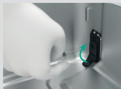
Retirez la sortie de condensat pour inspection.
