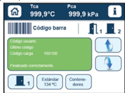
Parmi les nombreuses fonctionnalités offertes par le système de contrôle, il existe la possibilité d'envoyer un courrier électronique (à une adresse de courriel introduite au préalable dans le système) en cas de message d'alarme. Le système offre également la possibilité d'une connexion à distance avec le Service Technique afin de pouvoir faire un suivi du stérilisateur et même un diagnostic en cas de panne.
