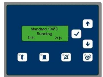
Pour les stérilisateurs à double porte, le côté de déchargement dispose d'un écran LCD avec une résolution de 4 x 20 caractères, ainsi que 7 touches de fonction.
