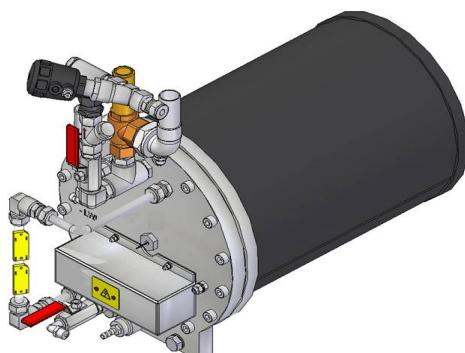
Les modèles SC500E-1/2, SC501E-1/2 et SC502E-1/2 sont dotés de générateurs de vapeur en acier inoxydable, fonctionnant automatiquement et avec une production de vapeur adaptée à la capacité du stérilisateur. Equipé d'un système de sécurité, d'un contrôle du niveau de l'eau par flotteurs, et d'un indicateur visuel de niveau dans la partie frontale.
