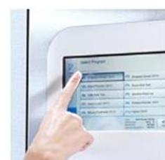
Par simple appui sur l'écran, l'opérateur a accès au contrôle des portes, à la sélection et au **démarrage du cycle**. Des **alertes** visuelles guident l'opérateur pour acquitter une alarme.
