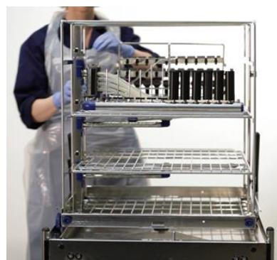
La solution Getinge d'accessoires corps creux propose une flexibilité à vos modules de lavage instruments avec des embases ouvertes configurables et évolutives qui se raccordent simplement en lieu et place d'un bras de lavage.
