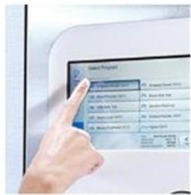
Par simple appui sur l'écran, l'opérateur a accès au contrôle des portes, à la sélection et au **démarrage du cycle**. Des **alertes** visuelles guident l'opérateur pour acquitter une alarme.
