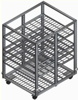
Châssis de chargement interne pour stérilisateurs S2000 série 2.1560-2.3100-2.4660-2.6200 pour l'industrie et les laboratoires. Construit en acier inoxydable de qualité AISI 304 / EN 1.4301 avec finition électropolie. Fourni avec 3 niveaux de charge, une tablette fixe dans la base et deux tablettes intermédiaires de hauteur variable, construites en tige d'acier inoxydable renforcée de la même qualité que le châssis.
