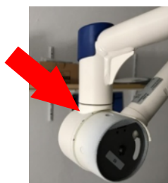
Vue de l'articulation sans bouchon. La vis de réglage se situe en haut.
