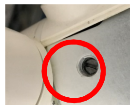
Réglez la force de ressort sur cette vis conformément aux instructions d'utilisation.
