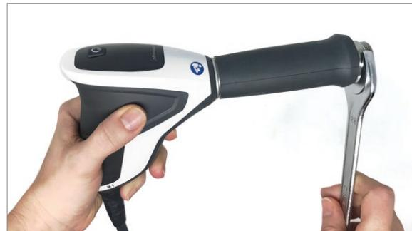
4. Revisser fermement le bouchon à vis du transmetteur sur la tige avec le transmetteur requis. Pour les bouchons de transmetteur composés de deux parties : S'assurer que les deux parties du bouchon sont bien vissées en position et que le bouchon à vis du transmetteur est fermement vissé sur la tige.
