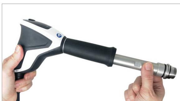
3. Tirer le tube de guidage serré hors de la tige. Le cas échéant, utiliser une tige métallique mince ou la clé hexagonale fournie comme outil de traction en l'insérant dans les ouvertures du tube de guidage.
