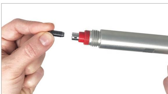
3. Visser la tige dans la pièce à main jusqu'à ce qu'elle soit bien serrée manuellement. Avec une main, appuyer fermement la pièce à main sur la table et serrer la tige à l'aide de la clé à fourche. La tige ne doit plus pouvoir être dévissée manuellement.
