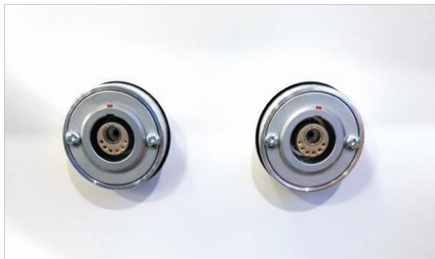
Pour connecter la pièce à main V-Actor HF, utiliser les connecteurs situés à l'avant de l'appareil. Le support de la pièce à main V-Actor se trouvant du côté gauche de l'appareil, il est recommandé d'utiliser le connecteur du côté gauche.
