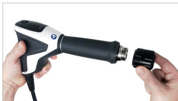
6. Après le remplacement du transmetteur d'impulsions, s'assurer que le bouchon de la pièce à main et les parties du bouchon sont fermement vissés en position.
