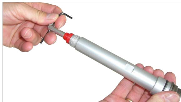
4. Un accessoire correspondant est fourni dans la poignée de la pièce à main pour maintenir le projectile en arrière. Pour retirer le projectile, tenir la poignée de la pièce à main en orientant son ouverture vers le bas. Frapper délicatement la poignée contre la surface de la table jusqu'à ce que le projectile tombe. Si le projectile venait à se casser en raison d'une surcharge, un fragment du projectile pourrait être laissé à l'intérieur du tube de guidage.
