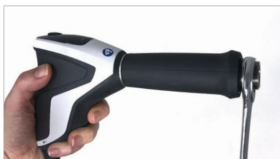
13. Revisser fermement le bouchon à vis du transmetteur sur la tige avec le transmetteur requis.
