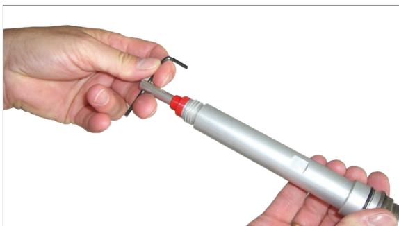
11. Insérer le projectile neuf dans le tube de guidage fixé.
