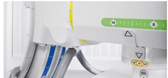
Les touches de déblocage et de blocage des freins pour les différents sens de déplacement sont repérées par des codes couleurs. Le boîtier comporte une échelle graduée de même couleur pour les sens de déplacement correspondants.
