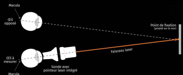
ProBeam™ est une exclusivité Quantel Medical. Cette sonde génère un faisceau laser qui offre un point de fixation au patient : cela facilite la mesure tout en augmentant la précision de celle-ci.<sup>2</sup>
