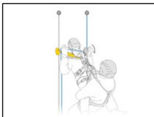
L'ASAP'SORBER AXESS peut être utilisé jusqu'à 250 kg dans le cadre d'un secours à deux personnes.
