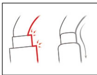
Le design intérieur fluide des mousquetons Sm'D limite le risque de point stable et facilite la rotation du mousqueton.
