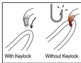
Pour garantir une efficacité optimale lors des manœuvres, les mousquetons Sm'D utilisent le système Keylock : l'interface, composée du corps et du doigt, est dépourvue de crochet, afin d'éviter l'accrochage involontaire du mousqueton sur l'ancrage, la corde, le porte-matériel du harnais...
