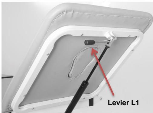
La tête est réglée avec vérin à gaz, activé avec un levier. Pour régler le proclive tirez le levier L1, réglez la position et relâchez le levier L1 pour fixer la position.
