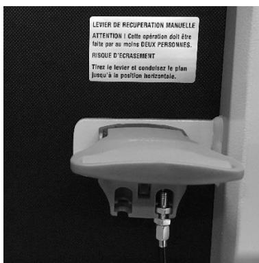
Tirez le levier et conduisez le plan jusqu'à la position horizontale.
