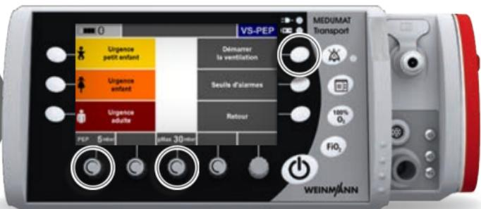
Régler ensuite les valeurs à l'aide du bouton de réglage : PEP (VS-PEP, VS-PEP/AI et BiLevel + AI), plnsp (uniquement BiLevel + AI), pMax (VS-PEP, VS-PEP/AI et BiLevel + AI), fréquence (uniquement BiLevel + AI) et I/E (uniquement BiLevel + AI). Suite à l'ajustement des valeurs correspondantes, démarrer la ventilation en sélectionnant « Démarrer la ventilation ».
