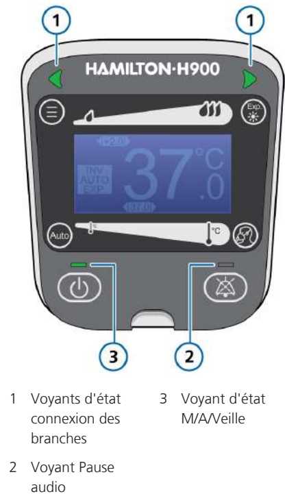
Figure 4. Humidificateur HAMILTON-H900, voyants d'état du panneau avant
