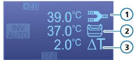
Abbildung 13. Fenster zur Temperaturüberwachung
