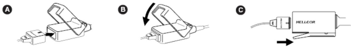
**1-** Il faut insérer le capteur Nellcor dans le connecteur à verrou en plastique transparent du câble DEC-4/8. Il faut s'assurer que l'inscription NELLCOR est visible en connectant la fiche du capteur au câble DEC-4/8. Et ensuite, on insère le capteur directement dans le connecteur, sans le faire tourner.
