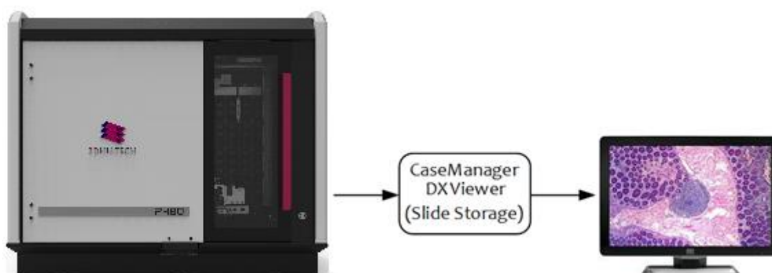
Figure 1 : Composants du système d'imagerie de lames entières (Whole Slide Imaging) Pannoramic® : scanner, IMS (système de gestion d'images) et moniteur
