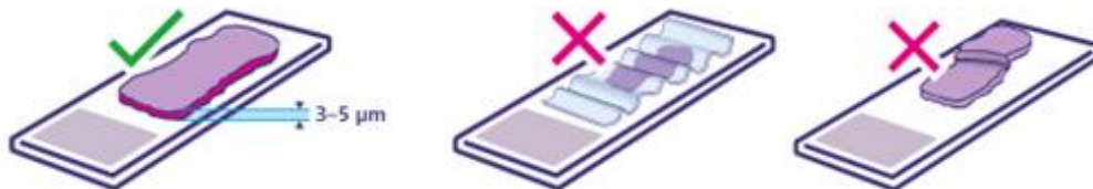
Figure 27 : Position appropriée ou inappropriée de l'échantillon tissulaire
