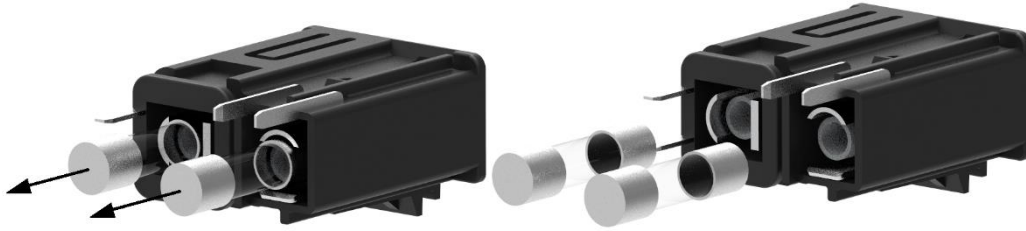
Figure 48 : Remplacement des fusibles
