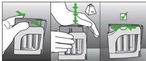
4. Placer la cartouche de réactifs dans une fente ouverte du carrousel de réactifs de l'appareil BIO-FLASH. Une fois la cartouche placée dans le carrousel de réactifs, l'instrument effectue un mélange périodique supplémentaire des billes.
