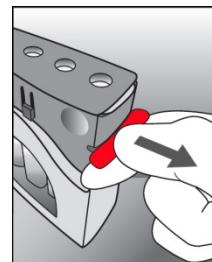
3. Appuyer sur les deux ailettes situées sur les côtés du capuchon perceur (partie grise) et appliquer une pression sur la partie supérieure de la cartouche de réactifs jusqu'à ce qu'elle s'enclenche en position verrouillée. Les ailettes ne doivent plus être visibles. NE PAS RETOURNER LA CARTOUCHE UNE FOIS OUVERTE.
