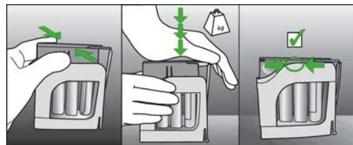
4. Placer la cartouche de réactifs dans une fente ouverte du carrousel de réactifs de l'appareil BIO-FLASH. Une fois la cartouche placée dans le carrousel de réactifs, l'instrument effectue un mélange périodique supplémentaire des billes.
