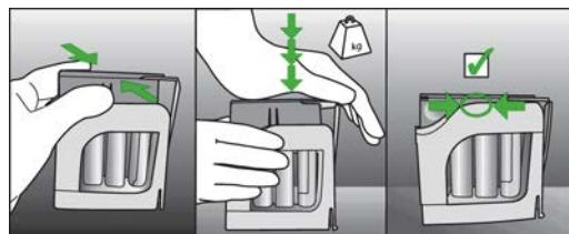
4. Placer la cartouche de réactifs dans une fente ouverte du carrousel de réactifs de l'appareil BIO-FLASH. Une fois la cartouche placée dans le carrousel de réactifs, l'instrument effectue un mélange périodique supplémentaire des microparticules.
