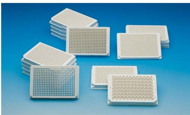
Plaque 96 ou 384 trous blanche à réflexions maximales, à auto-fluorescence et auto-luminescence minimale.
