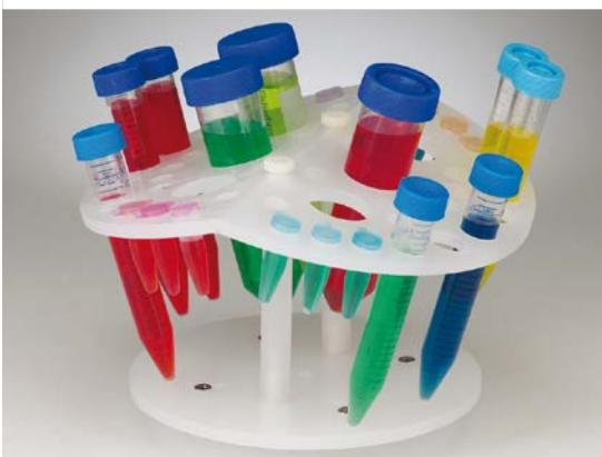
Support tube incliné pour 48 tubes : 18 tubes 1,5 ou 2 ml / 12 tubes 5 ml / 12 tubes 15 ml / 6 tubes 50 ml. Pour faciliter l'agitation du contenu des tubes sur une plate-forme à agitation.
