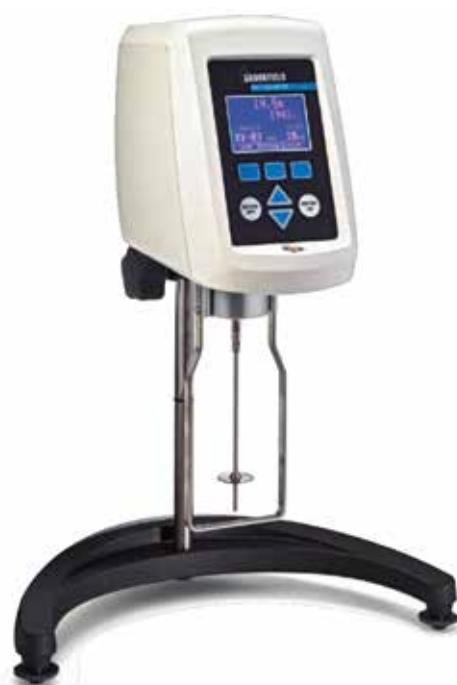
Pour mesure de la viscosité dans les produits liquides et pâteux.
