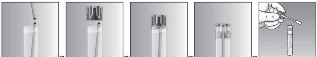
Abb. 3. Aufnahme des abgebrochenen Tupferstäbchens im Verschluss des FecalSwab™ Röhrchens
