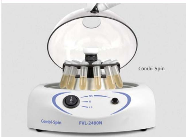
Livrées avec un rotor pour 12 tubes 1,5/2 ml, et un rotor pour 12 tubes 0,5 ml et 12 tubes 0,2 ml
