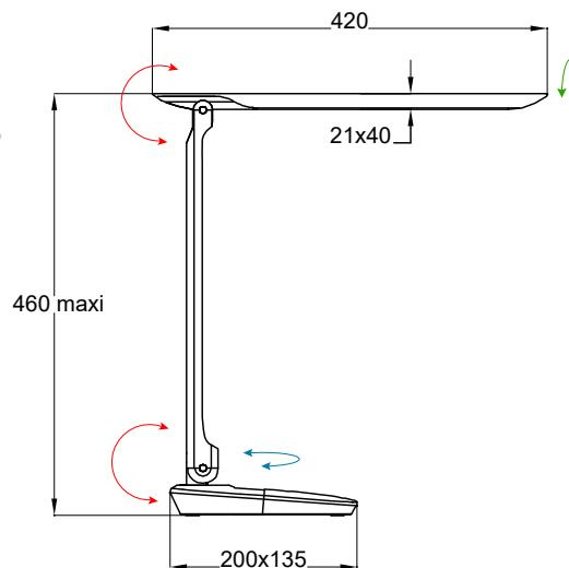
Cette lampe de bureau offre un éclairage asymétrique qui se pilote selon ses besoins pour un confort de travail optimal. Lampe orientable en tout sens grâce à 2 bras et 2 articulations. Réflecteur orientable également. Interrupteur sur la base.
