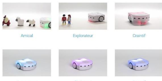
Ces comportements sont toujours présents dans le robot. Pour choisir un comportement, il suffit de démarrer le robot et de sélectionner une couleur grâce aux boutons flèches, le bouton central permettant de démarrer le comportement. Lorsque le comportement est actif, le bouton central permet de revenir au menu de sélection des comportements.
