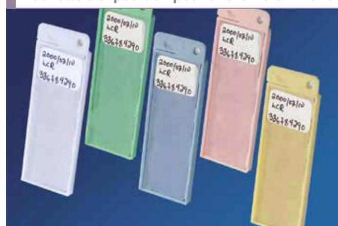
Pochette ingénieuse en plastique pour l'expédition d'une lame de microscope 76 x 26 mm.
