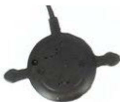
Capteur à conduction osseuse (inséré dans le rembourrage du bandeau tour de tête)
