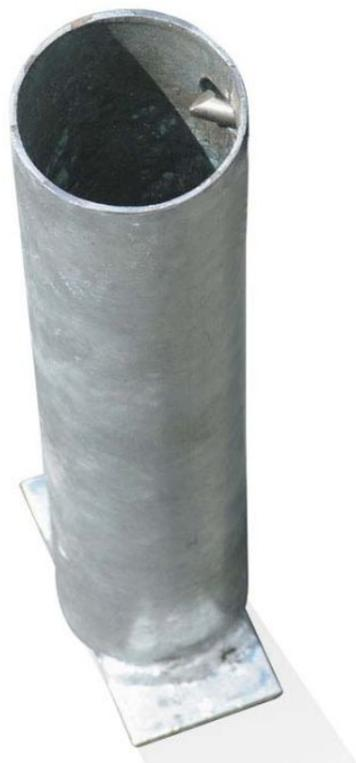
La boîte de scellement est fabriquée en acier galvanisé. Elle mesure 30 cm de long et dispose d'un diamètre total de 45 mm ou de 70 mm.
