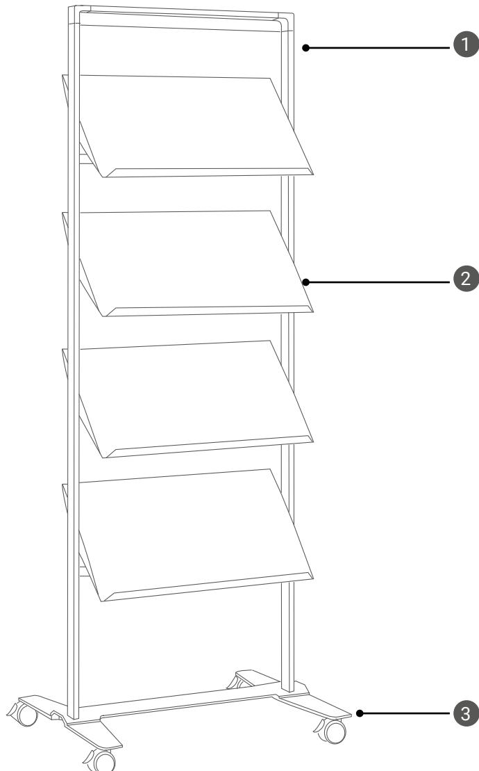
**1** Structure en acier thermolaqué tube 40 x 15 mm avec 2 angles de liaison aluminium, 2 traverses intermédiaires Ø 25 mm
