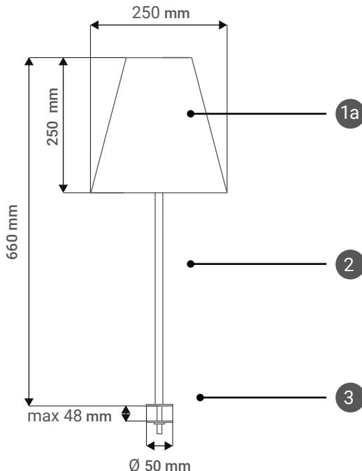
Abat-jour conique Vinyl 1 face couleur, finition mate (MA) ou brillant (BR), bordure ton sur ton, Ø 250 mm x H. 250 mm, comportement au feu à 850° conforme à la norme CEI 695.2.1/2
