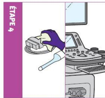
Utiliser Tristel Duo ULT pour une désinfection de haut niveau des surfaces pouvant entrer en contact avec la sonde, tels que les supports, les câbles et les connecteurs.
