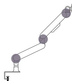
Présent à chaque articulation, il permet de limiter l'angle de rotation suivant 3 positions. Sans la gouille, rotation libre à 360°.
