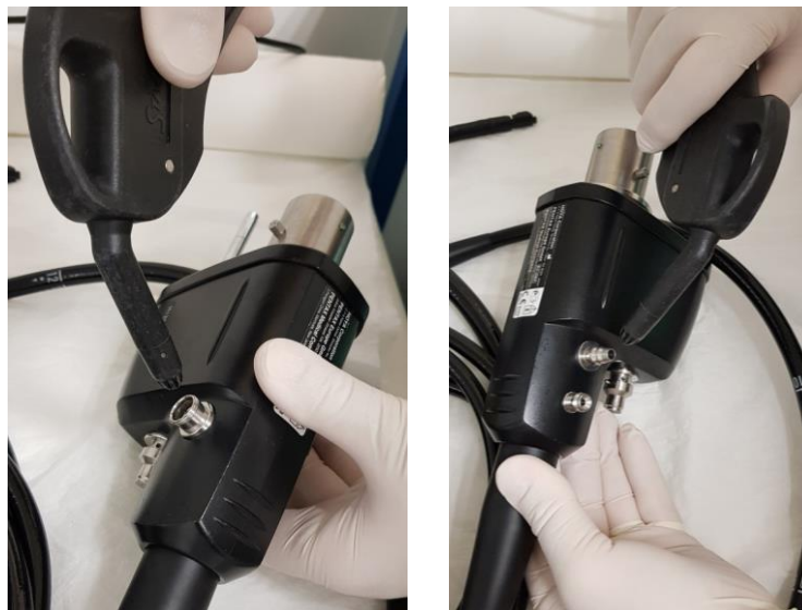
Figure 36. Séchage des connecteurs air/eau et aspiration.
