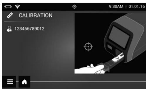
L'analyseur Sofia 2 indique quand le contrôle d'étalonnage est terminé (✓ ou ✗). Sélectionner pour revenir à l'écran Run Test (Exécuter test).
