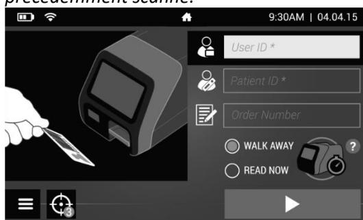
2. Saisir l'identifiant d'utilisateur et le n° de commande, le cas échéant, à l'aide du lecteur de code-barres ou saisir manuellement les données à l'aide du clavier tactile.
