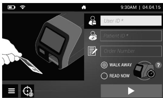
2. Entrer l'identifiant d'utilisateur ou le numéro de commande, le cas échéant, à l'aide du lecteur de code-barres ou saisir manuellement les données à l'aide du clavier tactile.
