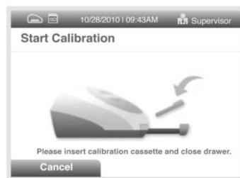
1. Après avoir reçu les invites du système, insérer la cassette d'étalonnage dans l'analyseur Sofia et fermer le tiroir. L'analyseur Sofia effectue le contrôle d'étalonnage automatiquement, en moins de deux minutes, sans que l'utilisateur n'ait besoin de faire quoi que ce soit.
