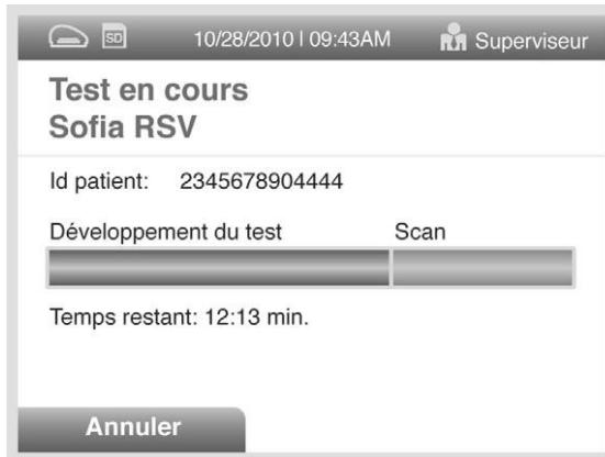
*Par exemple : cet écran indique que la durée restante du test en mode DIFFÉRÉ est 12 minutes et 13 secondes. L'analyseur Sofia lit et affiche les résultats après 15 minutes.*
