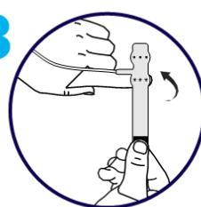
Placez les icônes de soleil sur le lit de l'ongle (ne les placez pas sur une articulation) et enroulez le capteur autour du doigt de manière que les icônes de points soient opposées aux icônes de soleil. Notez que le câble sera positionné sur le côté gauche du doigt sélectionné.
