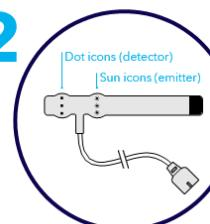
Nettoyez et enlevez toutes les substances telles que le vernis à ongles du site d'application du capteur. Retirez le support en plastique du capteur et localisez les composants optiques sous les icônes soleil (☀) et point (●).
