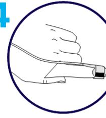
Enroulez fermement la longueur du bandage autour du site d'application du capteur, mais sans trop serrer. Branchez le capteur sur l'oxymètre et vérifiez son bon fonctionnement comme décrit dans le manuel d'utilisation de l'oxymètre.
