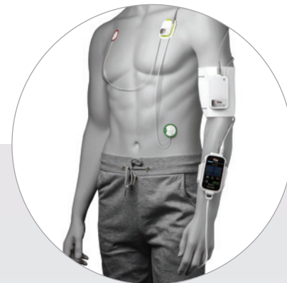
Radius VSM avec SpO2, PNI, ECG, température corporelle en continu, fréquence respiratoire acoustique et surveillance de l'orientation, de la position et de l'activité du patient
