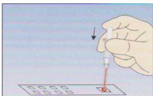
L'échantillon de sang total peut être distribué avec précision en appuyant sur le piston.
