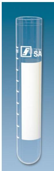
**Désignation commerciale :** Tube 5ml, gradué et aplat, polystyrène, fond rond, non stérile.
